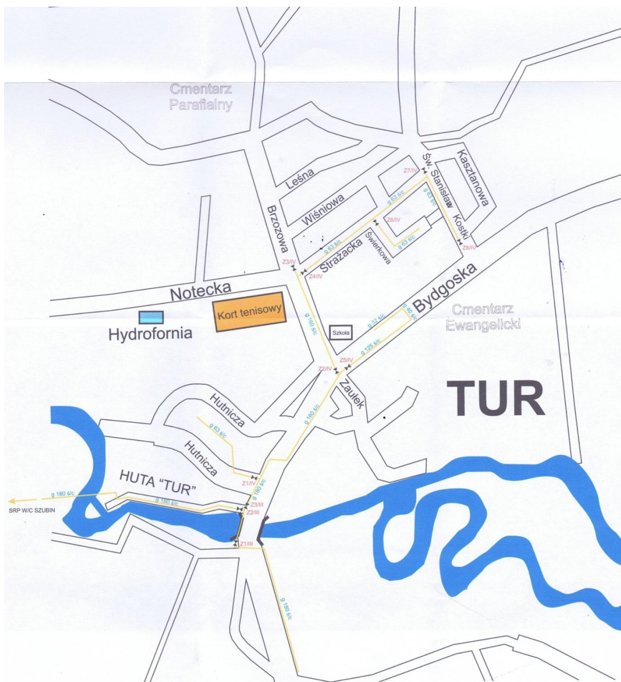
Ryc. 6. Przebieg sieci gazowej na terenie miejscowości Tur
